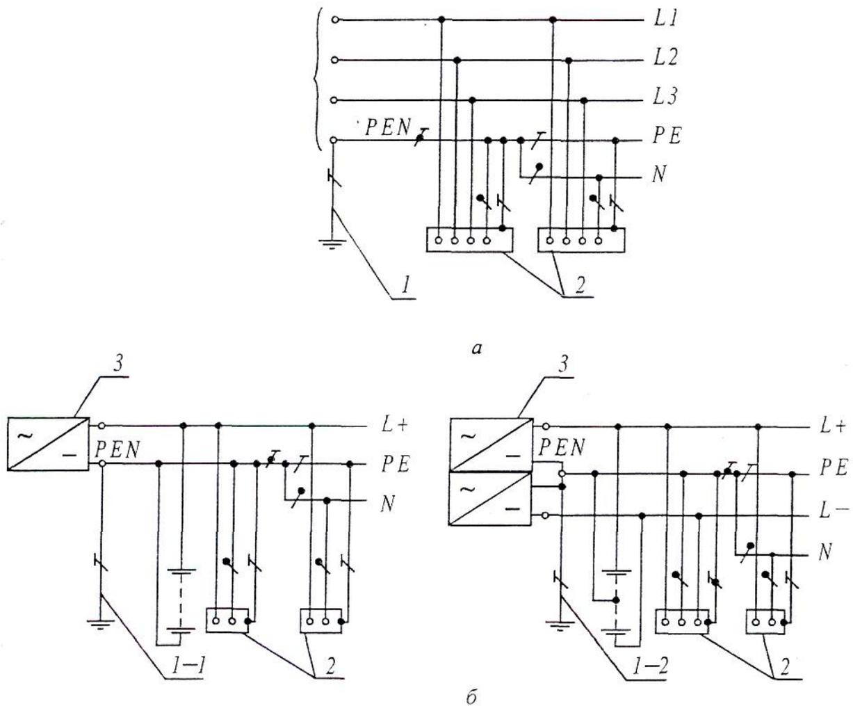
**Рис. 1.7.3. Система TN-C-S переменного (а) и постоянного (б) тока. Нулевой защитный и нулевой рабочий проводники совмещены в одном проводнике в части системы:**
