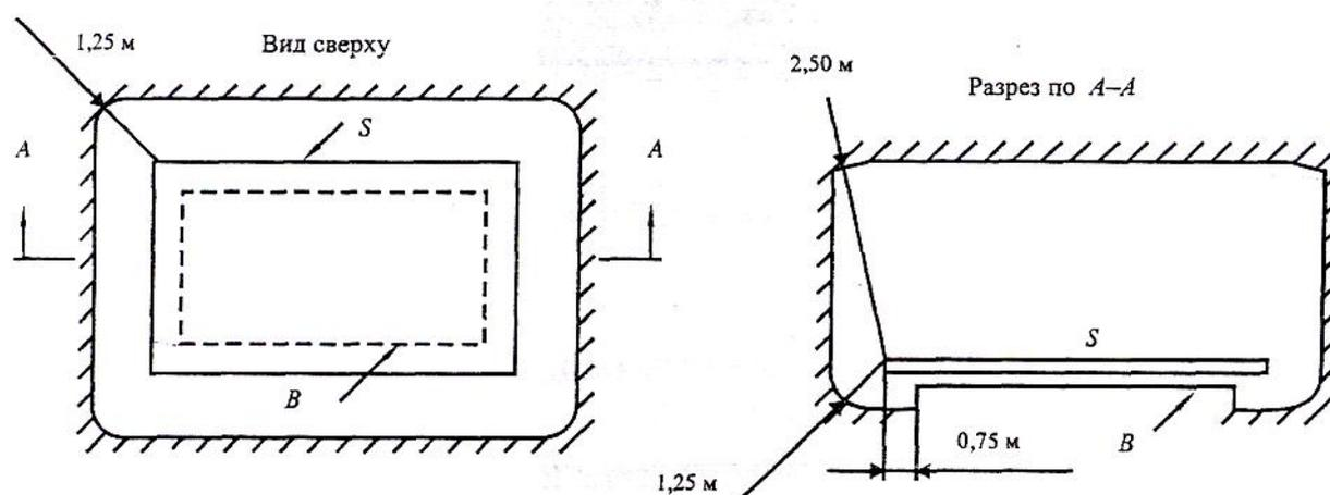
**Рис. 1.7.6. Зона досягаемости в электроустановках до 1 кВ:**
