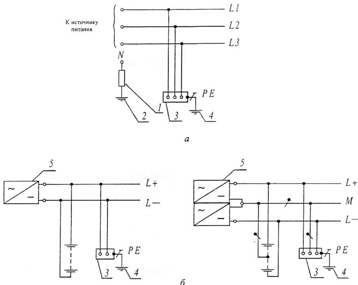
**Рис. 1.7.4. Система IT переменного (а) и постоянного (б) тока. Открытые проводящие части электроустановки заземлены. Нейтраль источника питания изолирована от земли или заземлена через большое сопротивление:**
